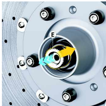
Fig. 92 : Contrôle de l'axe de sécurité
