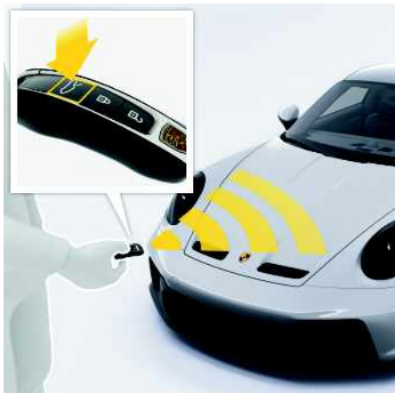
Fig. 16 : Ouverture du capot du coffre à bagages avec la clé du véhicule
