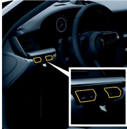
Fig. 56 : Panneau de commande de l'éclairage
