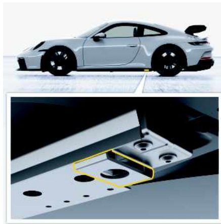
Fig. 52 : Point de logement pour cric ou pont élévateur à l'arrière
