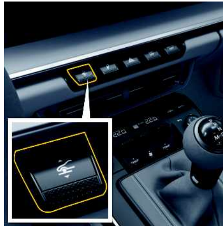
Fig. 150 : Touche du système de levage
