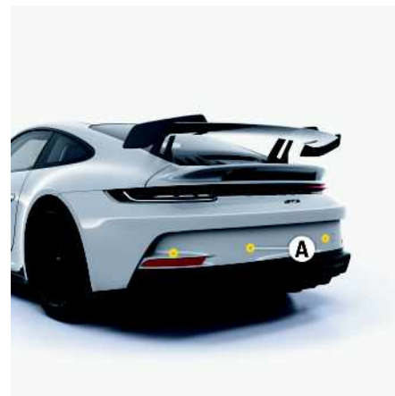
Fig. 4 : Capteurs à ultrasons utilisés pour la mesure de la distance
