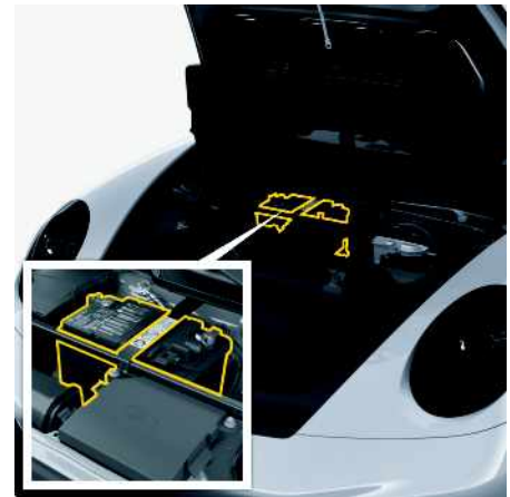
Fig. 6 : Batterie au lithium
