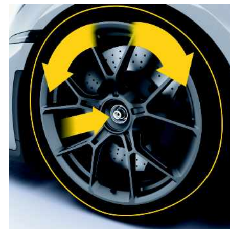
Fig. 93 : Installation de la roue sur le moyeu de roue
