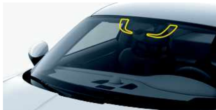
Fig. 76 : Fixation des appareils de péage
