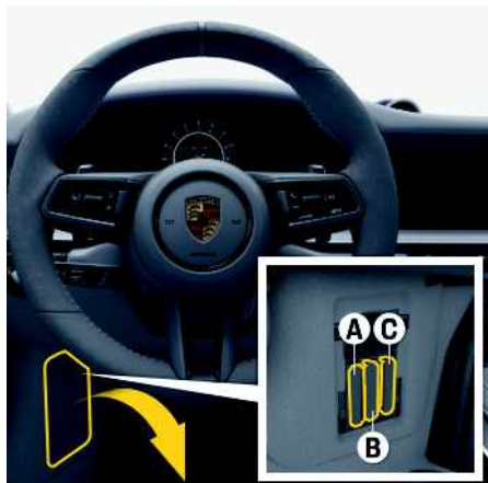
Fig. 65 : Boîte à fusibles dans le plancher côté conducteur
