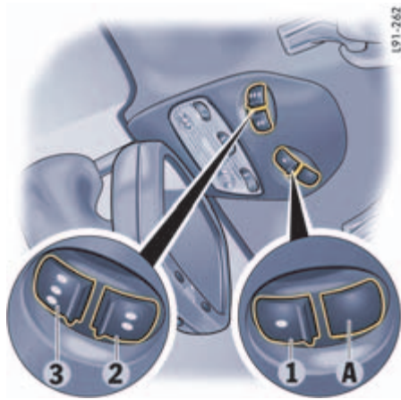
1, 2, 3 - Touches programmables A - Diode luminescente pour la reconnaissance de l'état
