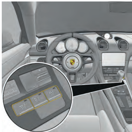
Fig. 67 : Touches de répartition de l'air
