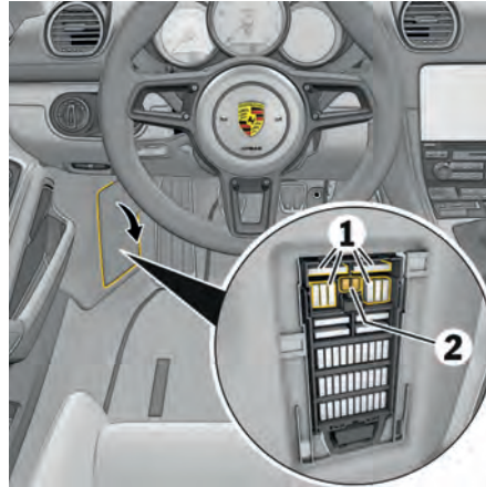
Fig. 125 : Éléments dans la boîte à fusibles au niveau du plancher côté gauche
