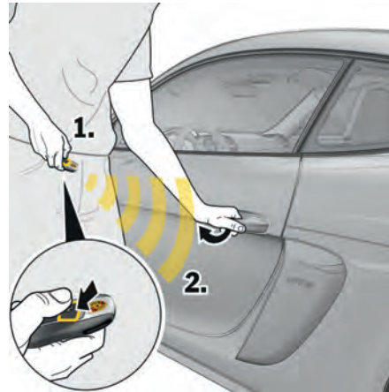
Fig. 223 : Déverrouillage des portes à l'aide de la clé du véhicule
