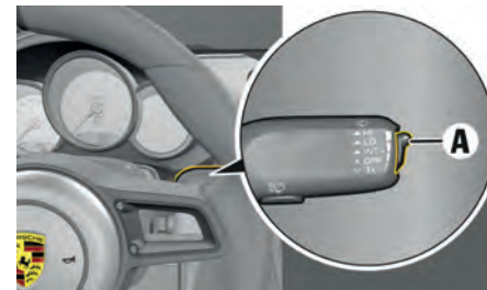
Fig. 112 : Commutateur de réglage de la sensibilité du capteur de pluie / mode intermittent A
