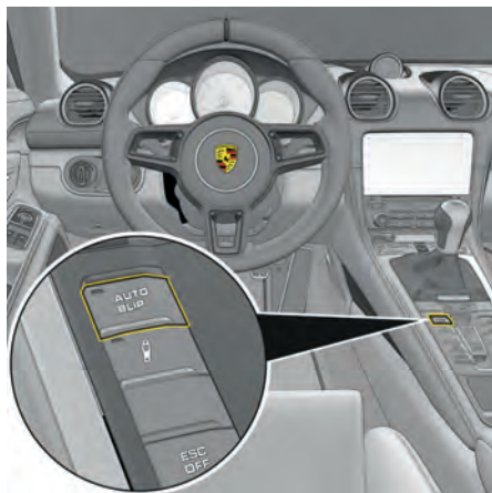
Fig 19: AUTO BLIP (fonction de double débrayage automatique)
