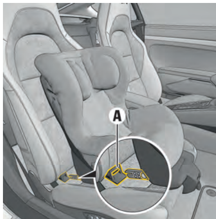
Fig. 216 : Installation d'un système de retenue pour enfants avec système ISOFIX
