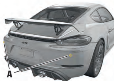
Fig. 9 : Capteurs à ultrasons utilisés pour la mesure de la distance
