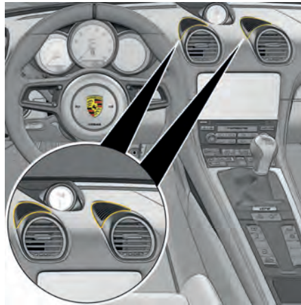
Fig. 60 : Zone de ventilation supérieure
