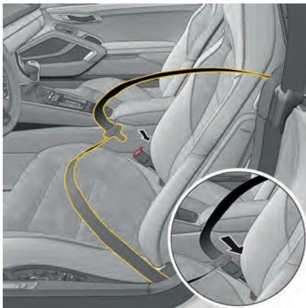
Fig. 43 : Mise en place de la ceinture de sécurité
