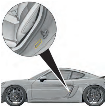
Fig. 151 : Plaque de pression des pneumatiques dans la feuillure de la porte.
