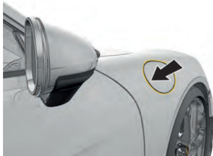
Fig. 187 : Ouverture de la trappe du réservoir
