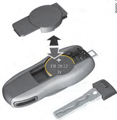
Fig. 51 : Remplacement de la pile
