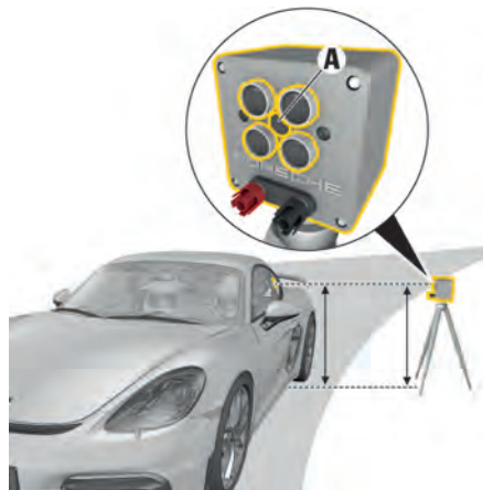
Fig. 137 : Mise en place de l'émetteur
