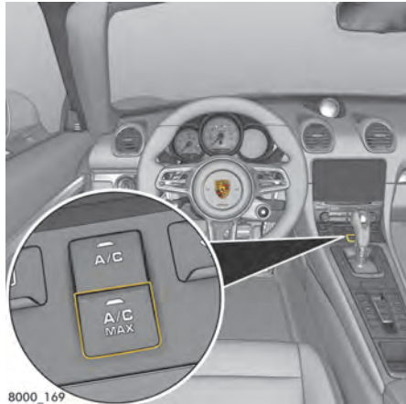
8000_169 Fig 77 : Activation du refroidissement maximal
