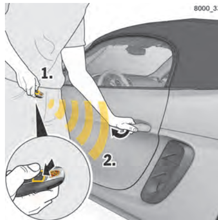
Fig 235 : Déverrouillage des portes à l'aide de la clé du véhicule
