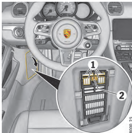
Fig 128 : Éléments dans la boîte à fusibles au niveau du plancher côté gauche
