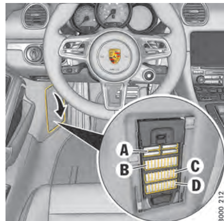
Fig 129 : Porte-fusibles au niveau du plancher côté conducteur
