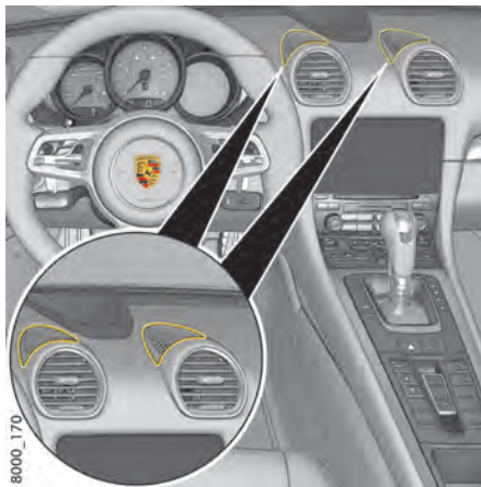
Fig 67 : Zone de ventilation supérieure
