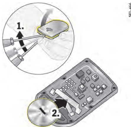
Fig 174 : Remplacement de la pile de la carte conducteur
