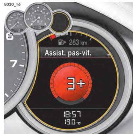
Fig 124 : Exemple de recommandation de changement de rapport
