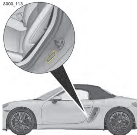
Fig 150 : Plaque de pression des pneumatiques dans la feuilleure de la porte.
