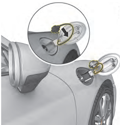
Fig 185 : Ouverture du bouchon du réservoir
