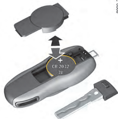
Fig 58 : Remplacement de la pile
