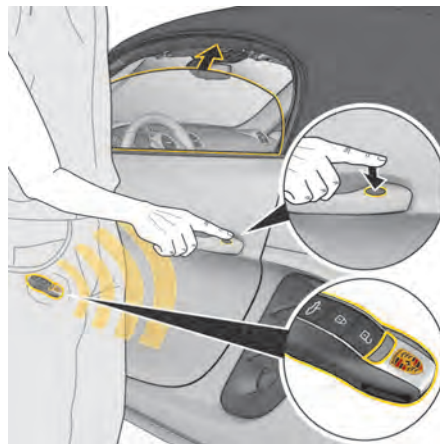
Fig 244 : Fermeture des vitres latérales à l'aide du détecteur de proximité intégré à la poignée de porte (véhicules avec Porsche Entry & Drive)
