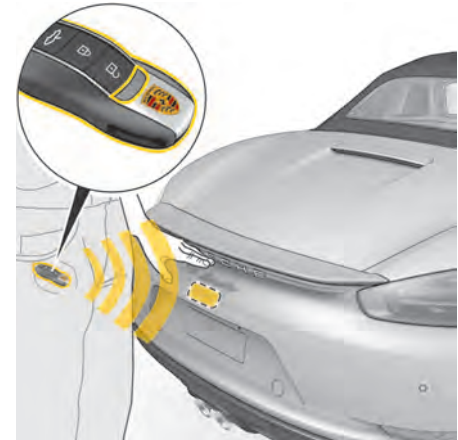
Fig 36 : Ouverture du capot du coffre à bagages arrière avec Porsche Entry & Drive
