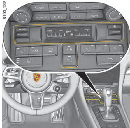
Fig 72 : Panneau de commande de la climatisation
