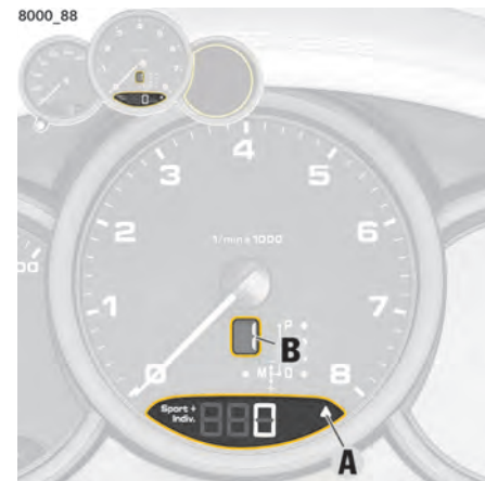
Fig 26: Indicateur de passage au rapport supérieur A et affichage du rapport B
