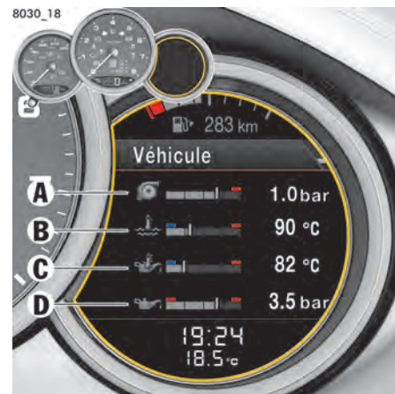
Fig 189 : Exemple de configuration de la zone d'information
