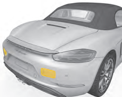
Fig 10 : Capteurs radar dans le pare-chocs arrière
