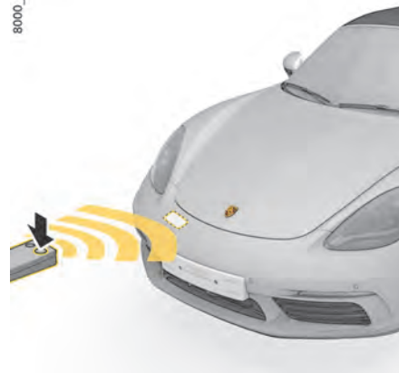
Fig 92 : Positionnez l'émetteur manuel d'origine face au véhicule
