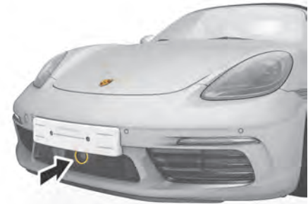
Fig 191 : Position du capteur radar
