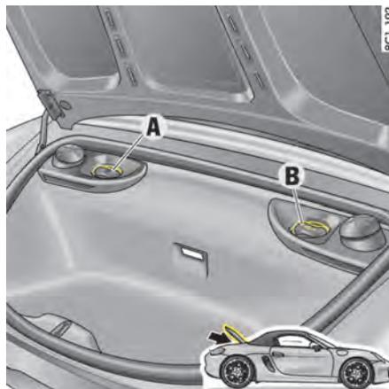
**A** - Station de remplissage de liquide de refroidissement
