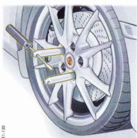
Vissage de **deux** auxiliaires de montage sur les véhicules avec PCCB
