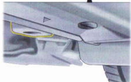
Point de logement pour pont élévateur et cric à l'arrière
