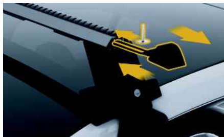
Fig. 204 : Découpe et mise en place des caches profilés
