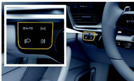
Fig. 90 : Panneau de commande de l'éclairage
