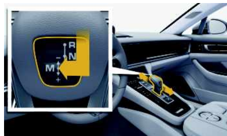
Fig. 25 : Mode manuel sur le levier sélecteur
