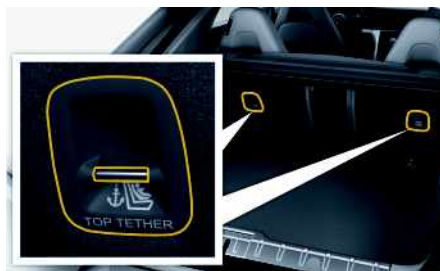
Fig. 215 : Véhicules avec 2 sièges à l'arrière : points de fixation du point d'ancrage ISOFIX (Top Tether)
