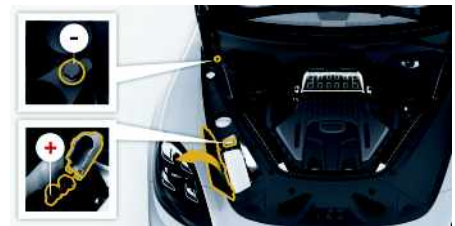
Fig. 22 : Recharge de la batterie
