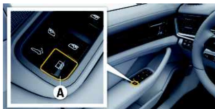
Fig. 158 : Touche A : démarrer le dégazage du réservoir et déverrouiller la trappe du réservoir de carburant
