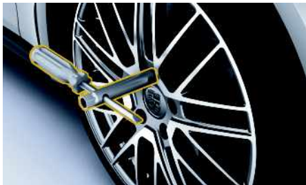
Fig. 123 : Vissage d'un auxiliaire de montage sur les véhicules sans PCCB
