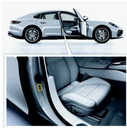
Fig. 243 : Emplacement de la plaque signalétique
