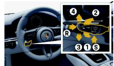
Fig. 3 : Utilisation de l'alerte de franchissement de ligne
