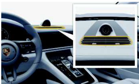
Fig. 51 : Zone de ventilation supérieure
