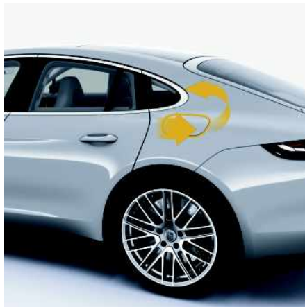
Fig. 162 : Ouverture de la trappe de charge
