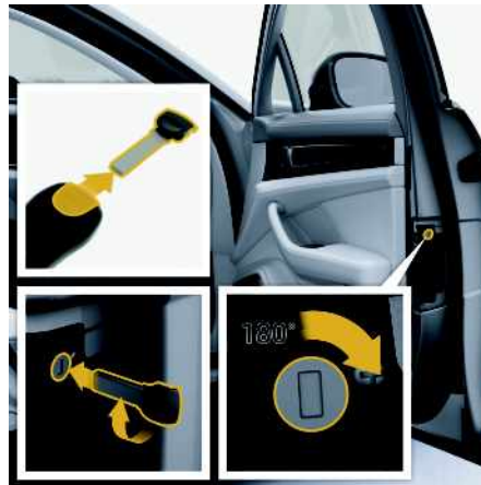
Fig. 232 : Procéder au verrouillage de secours de la porte passager
