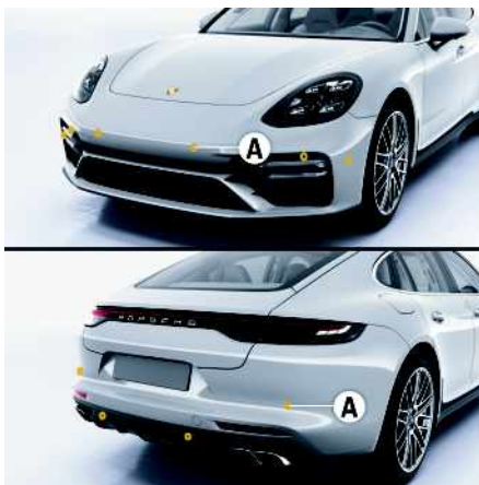
Fig. 18 : Capteurs à ultrasons utilisés pour la mesure de la distance
