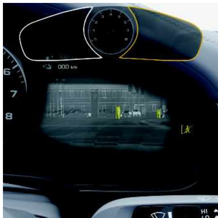
Fig. 28 : Image des différences thermiques de la caméra de vision nocturne
