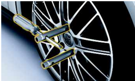
Fig. 124 : Vissage de deux auxiliaires de montage sur les véhicules avec PCCB
