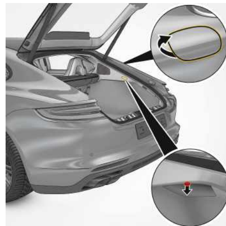
Fig. 159: Déverrouillage d'urgence de la trappe du réservoir
