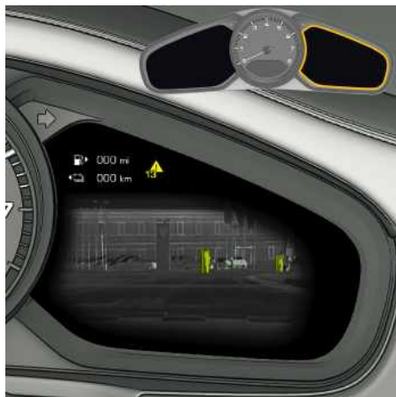
Fig. 27: Image des différences thermiques de la caméra de vision nocturne
