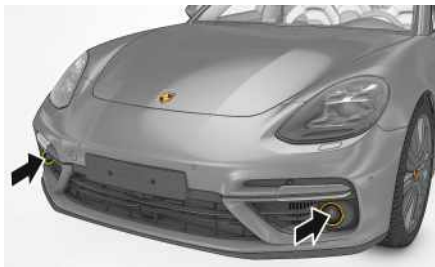
Fig. 170: Position des capteurs radar
