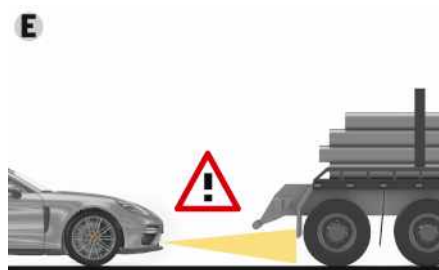
Fig. 176: Véhicules à fort porte-à-faux
