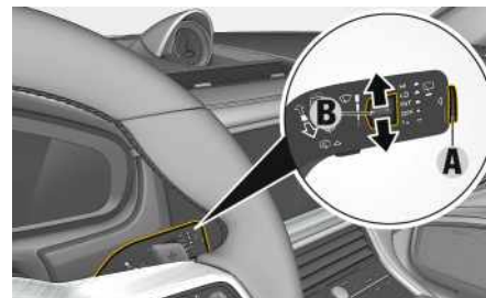
Fig. 95: Touche d'essuie-glace arrière A et commutateur de réglage de la sensibilité du capteur de pluie B
