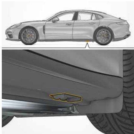
Fig. 83: Point de logement pour pont élévateur et cric à l'arrière
