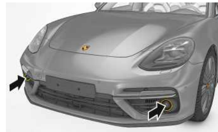
Fig. 178: Position des capteurs radar
