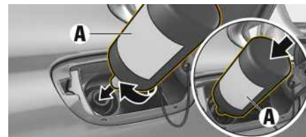
Fig. 161: Versez l'AdBlue® avec la bouteille
