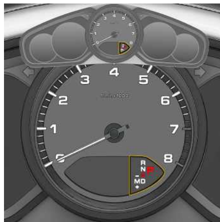
Fig. 23: Lecture de l'affichage du mode de fonctionnement et du rapport engagé dans le combiné d'instruments
