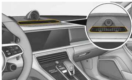
Fig. 49: Zone de ventilation supérieure
