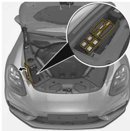
Fig. 103: Boîte à fusibles dans le compartiment moteur
