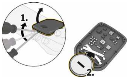
Fig. 144: Remplacement de la pile de la carte conducteur PVTS Plus
