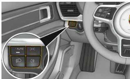
Fig. 88: Panneau de commande de l'éclairage
