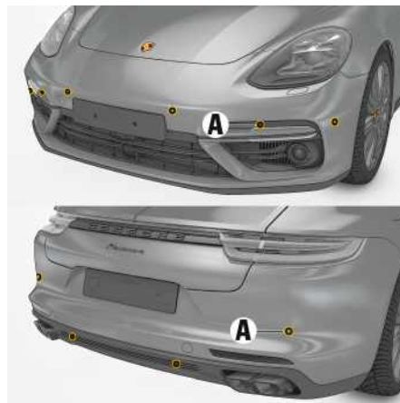
Fig. 17: Capteurs à ultrasons utilisés pour la mesure de la distance
