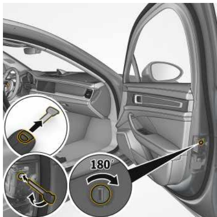
Fig. 233: Procéder au verrouillage de secours de la porte passager
