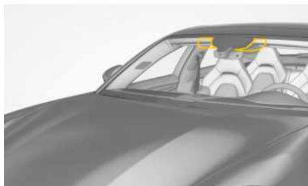
Fig. 117: Fixation des appareils de péage
