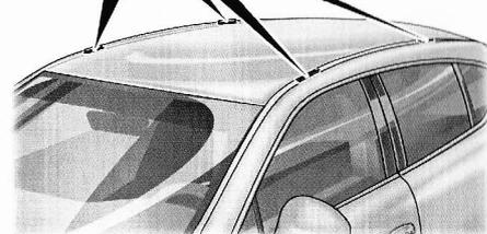
8. Positionnez avec précaution le support dans les moulures de fixation. Les protections de canal de toit **E** restent collées définitivement dans la moulure de fixation. La peinture dans les moulures de fixation est ainsi protégée en cas de montage répété du système de transport sur toit et le montage est plus facile.
