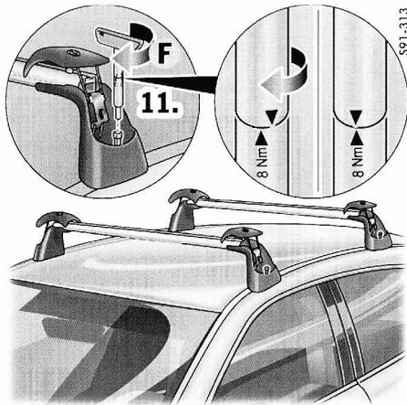
**11.** Serrez les vis de fixation avec la clé dynamométrique **F** jusqu'à ce que les flèches de la clé correspondent parfaitement.
