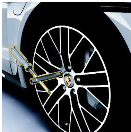
Fig. 122 : Vissage d'un auxiliaire de montage sur les véhicules sans PCCB
