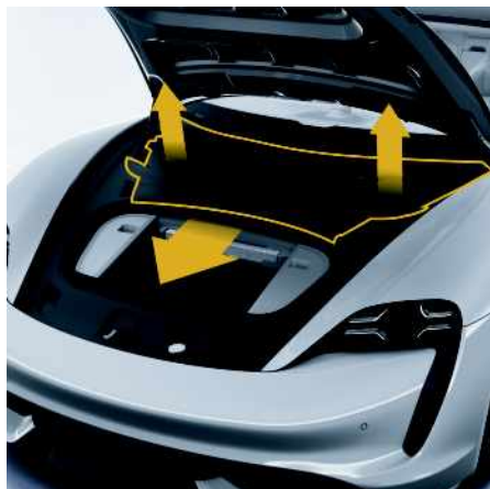
Fig. 64 : Dégagement et soulèvement du cache en plastique
