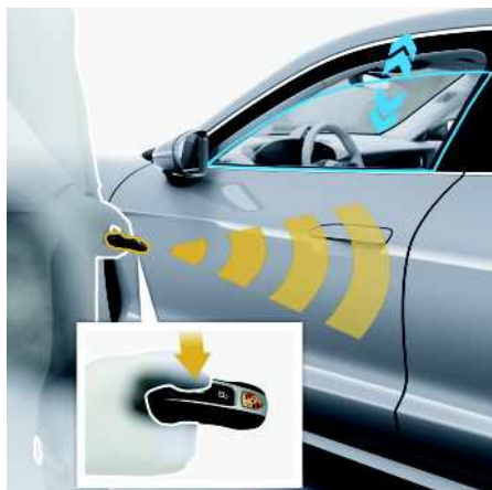
Fig. 232 : Ouverture et fermeture des vitres latérales avec la clé du véhicule
