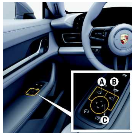
Fig. 176 : Pivotement du rétroviseur vers le bas pour l'assistance au stationnement
