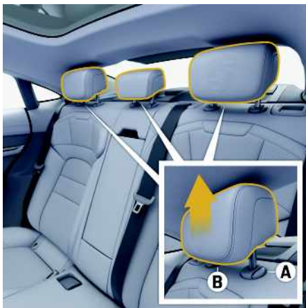
Fig. 183 : Dépose et repose des appuie-tête des sièges arrière
