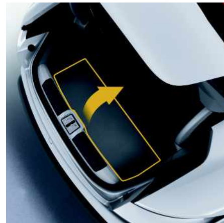
Fig. 66 : Ouverture du plancher du coffre à bagages
