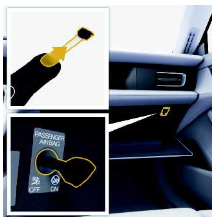
Fig. 205 : Désactivation de l'airbag passager
