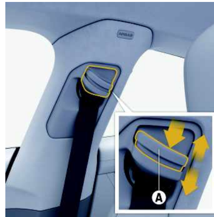
Fig. 40 : Réglage de la hauteur de la ceinture
