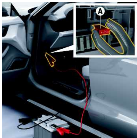
Fig. 37 : Déverrouillage d'urgence du capot avant - Raccordement de la borne plus
