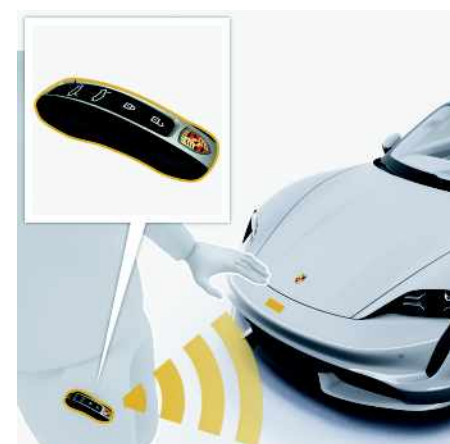
Fig. 35 : Ouverture du capot avant avec accès Confort
