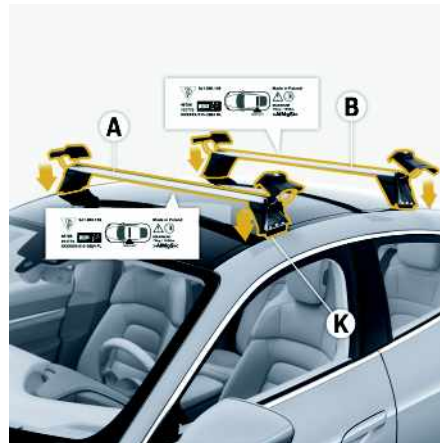
Fig. 198 : Montage des supports sur le toit
