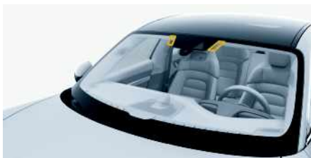
Fig. 113 : Fixation des appareils de péage
