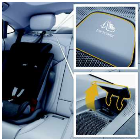
Fig. 216 : Points de fixation du point d'ancrage (Top Tether)
