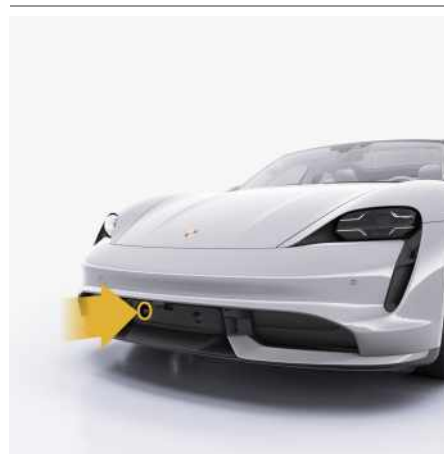
Fig. 135 : Position du capteur radar
