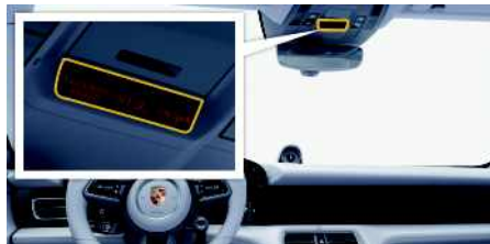
Fig. 204 : Indicateur PASSENGER AIR BAG OFF/ON
