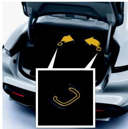
Fig. 68 : Utilisation des œillets d'arrimage
