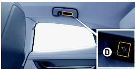
Fig. 88 : Utilisation des lampes de lecture
