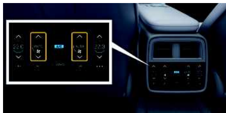
Fig. 57 : Réglage du débit d'air à l'arrière
