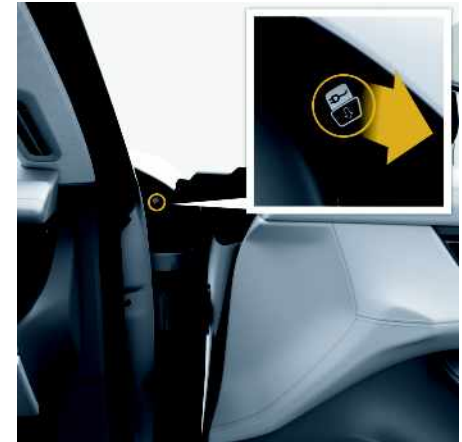
Fig. 160 : Procédure de déverrouillage d'urgence du connecteur de charge du véhicule
