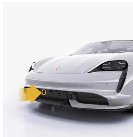
Fig. 162 : Position du capteur radar
