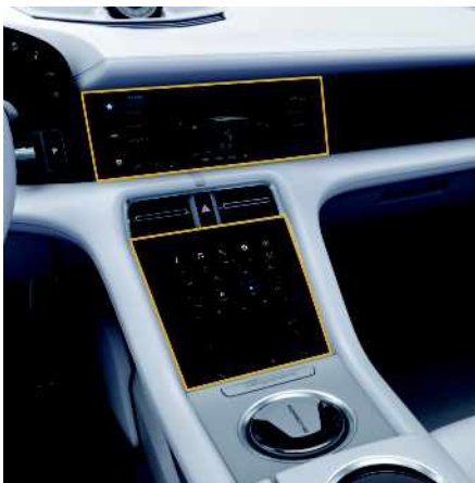
Fig. 4 : Panneaux de commande de la climatisation
