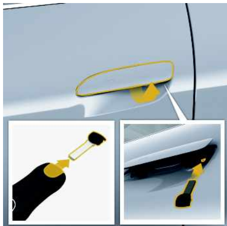
Fig. 229 : Déverrouillage / verrouillage de secours
