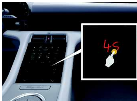
Fig. 132 : Saisie à main levée dans le module de commande de la console centrale
