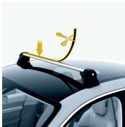
Fig. 201 : Découpage et pose du cache profilé
