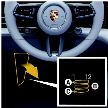
Fig. 94 : Ouverture de la boîte à fusibles au niveau du plancher à gauche
