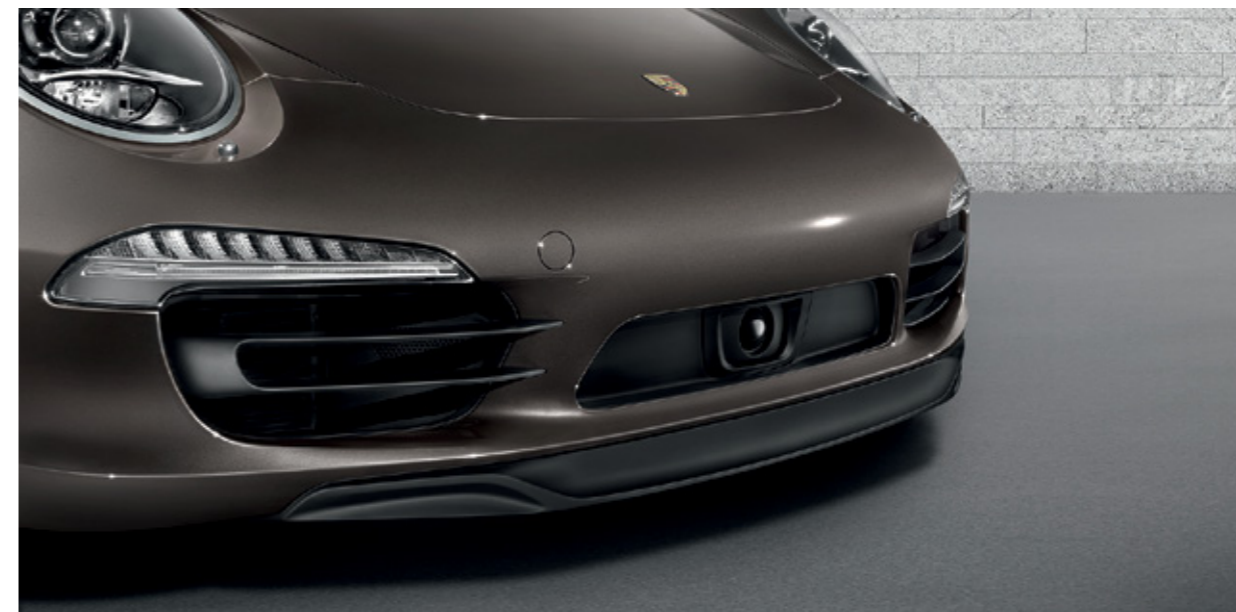
Radar du régulateur de vitesse adaptatif
