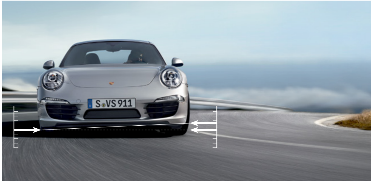
Passage rapide en virage d'une 911 Carrera non équipée du système PDCC (schéma de principe)
