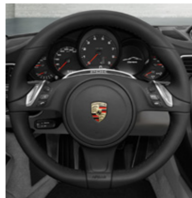
Volant multifonction pour boîte PDK
