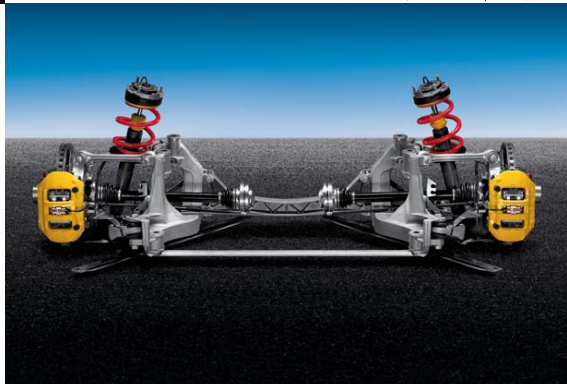
Essieu arrière 911 GT3 doté de freins PCCB (Porsche Ceramic Composite Brake)
