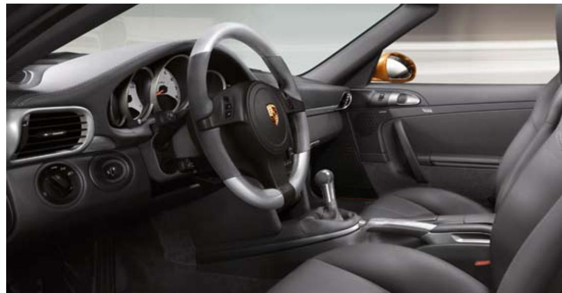
Volant multifonction à 3 branches en AluDesign, leviers de vitesse et de frein à main en aluminium (Design I)
