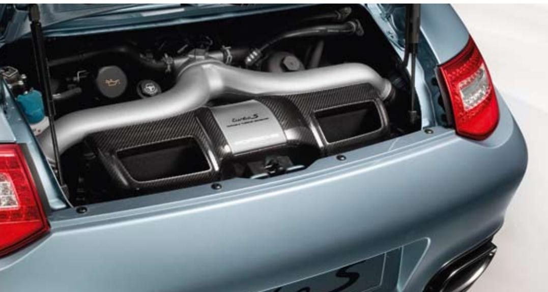
Moteur avec boîtier de filtre à air en carbone des nouveaux modèles 911 Turbo S
