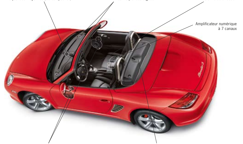
Haut-parleur central 7,0 cm pour les fréquences moyennes (Centerspeaker)
