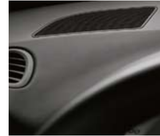
Enceinte néodyme 2,5 cm pour les fréquences aiguës
