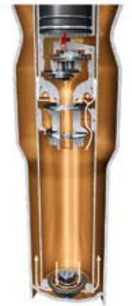
Phase de compression – Piston seul = réglage sportif ferme
