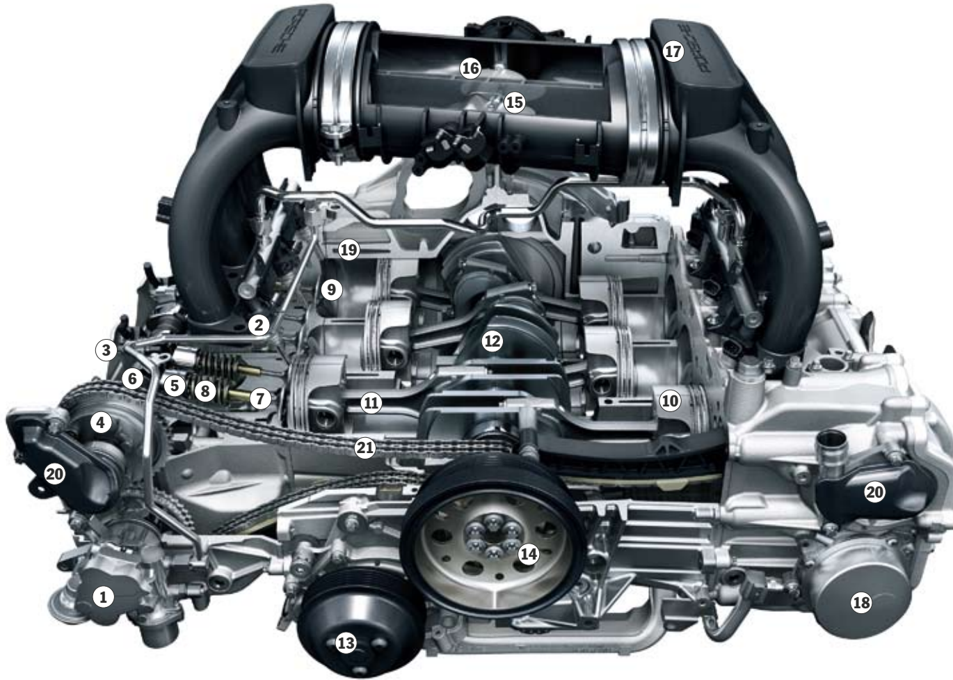
Moteur Boxer 6 cylindres (3,4 litres de cylindrée) du Boxster S
