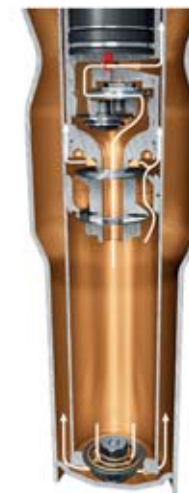
Phase de compression – Piston plus by-pass = réglage sportif confortable
