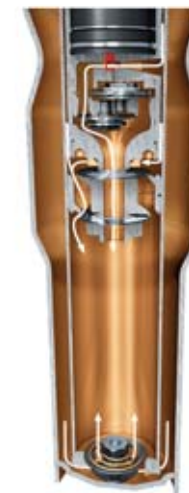
Phase de détente – Piston seul = réglage sportif confortable
