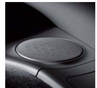
Enceinte néodyme 8,0 cm pour les fréquences moyennes
