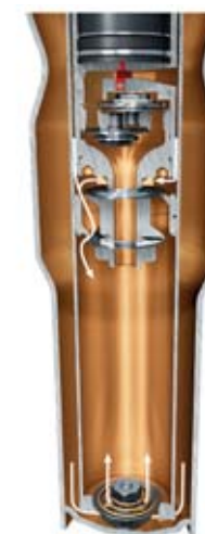
Phase de détente – Piston seul – réglage sportif plus ferme
