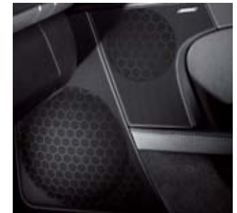
Une enceinte néodyme de 8,0 cm pour les fréquences moyennes et une de 20,0 cm pour les graves*
