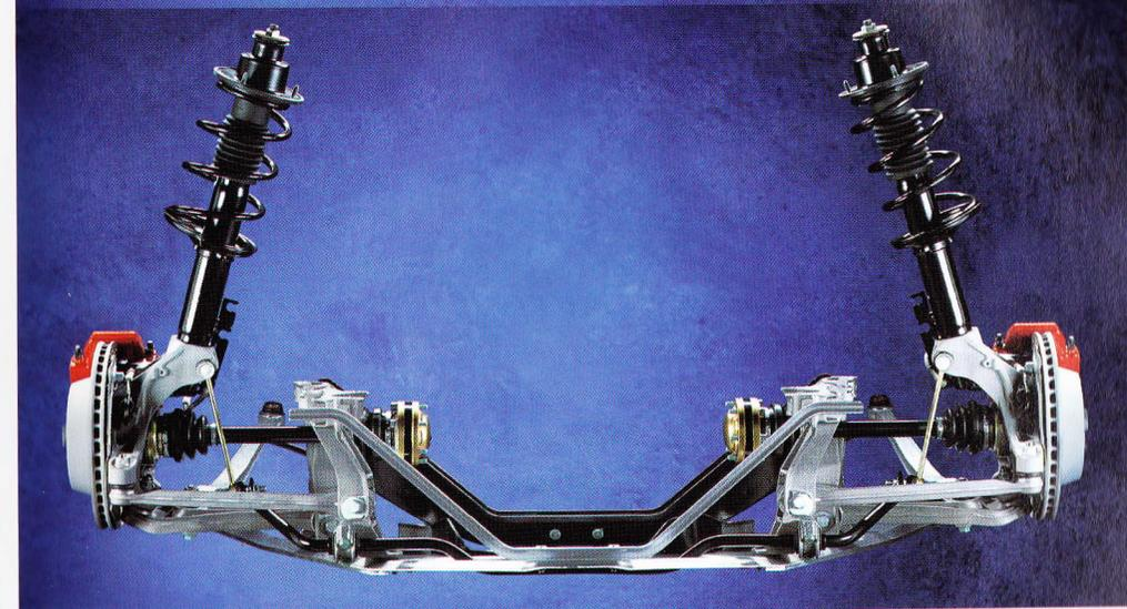
Essieu McPherson avec bras de suspension, jambe de force et étriers de freins rouges sur le Boxster S
