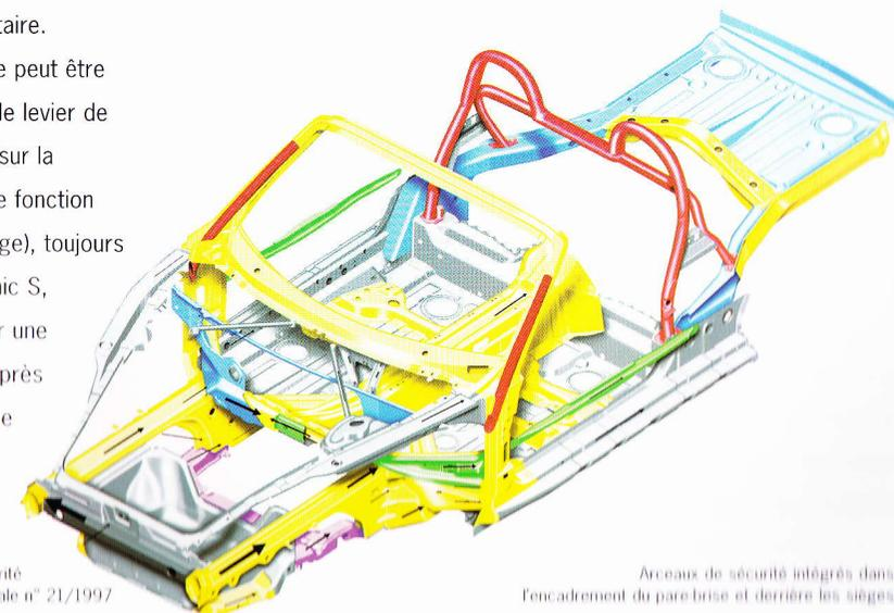
Arceaux de sécurité intégrés dans l'encadrement du pare-brise et derrière les sièges
