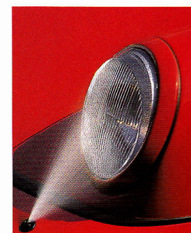
Une pompe haute pression lave les phares des Carrera 2 et 4
