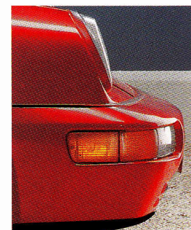
Les pare-chocs en Bexloy protègent contre les jets de pierres
