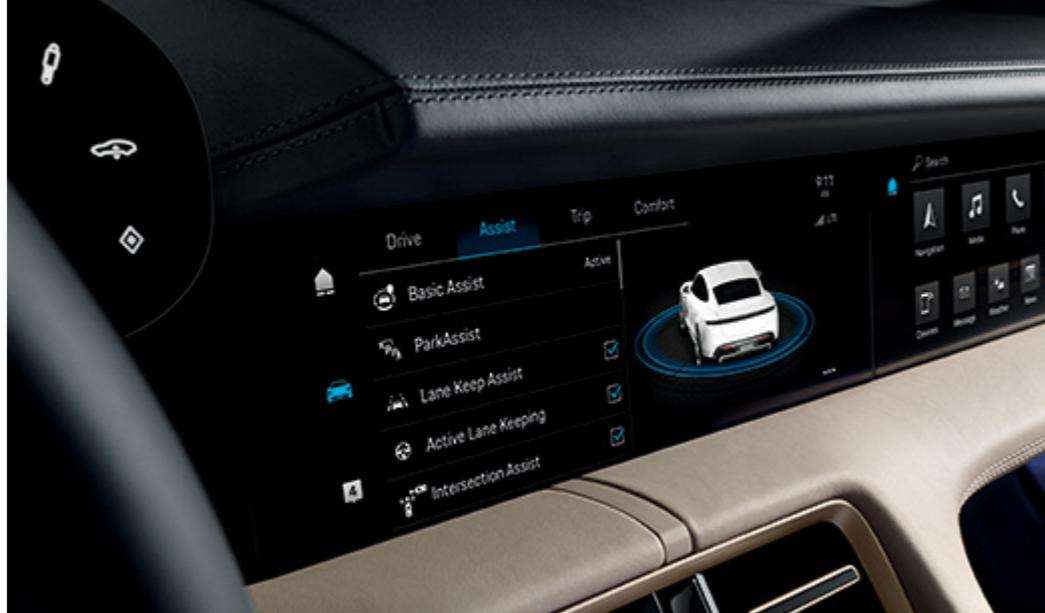
système – de même que l'**assistance embouteillage**, qui maintient le véhicule au milieu de la voie en cas d'embouteillage, pour plus de confort sur les longs trajets.
