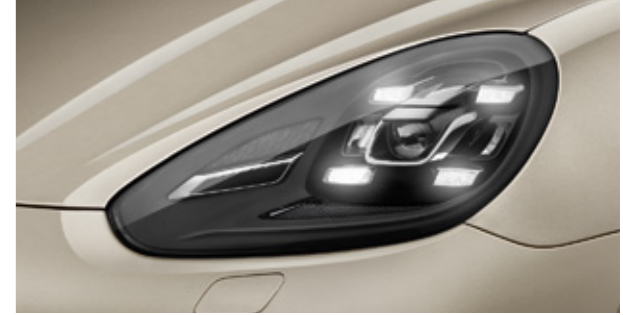
Phares à DEL avec fonction Porsche Dynamic Light System Plus (PDLS+)
