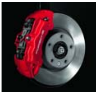
Freins avant de série sur le Cayenne GTS – Diamètre du disque de frein : 350 mm
