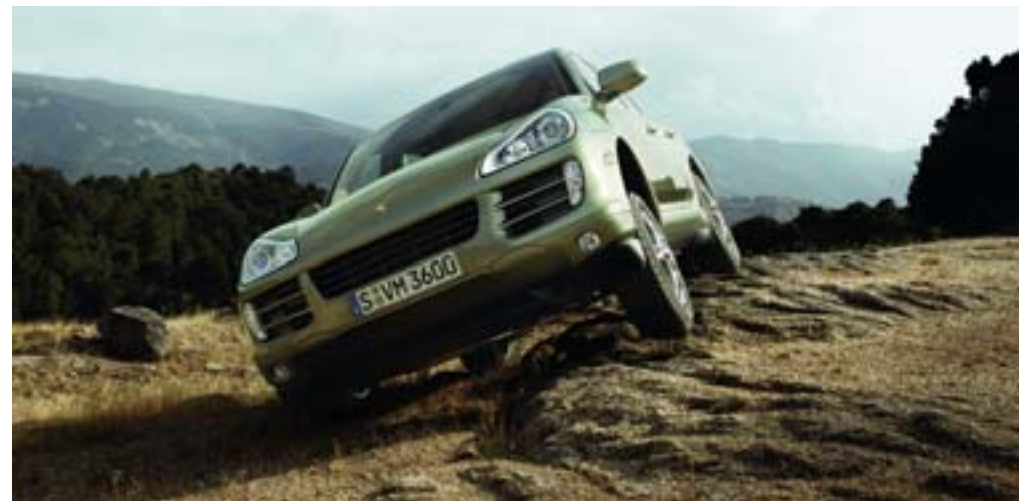
PDCC en mode « Off-road » (tout-terrain) : exemple de situation illustrant un croisement de pont accru
