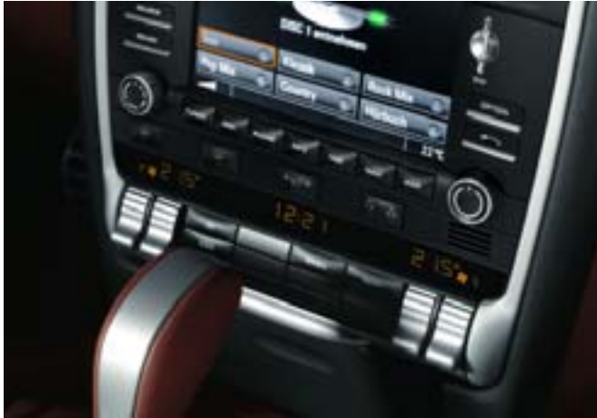
Commande de climatisation avec volet ouvert
